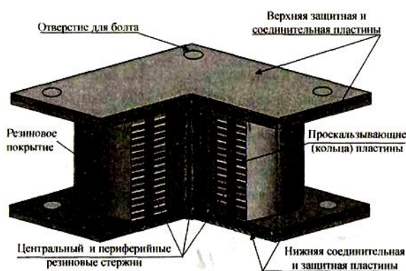
Рис.2. Фрикционная опорная часть марки R-FBJ
